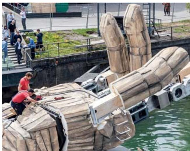
Links: Sieben Hydraulikzylinder bewegen Kopf und Hand. Der längste misst im ausgefahrenen Zustand 7,5 Meter.
